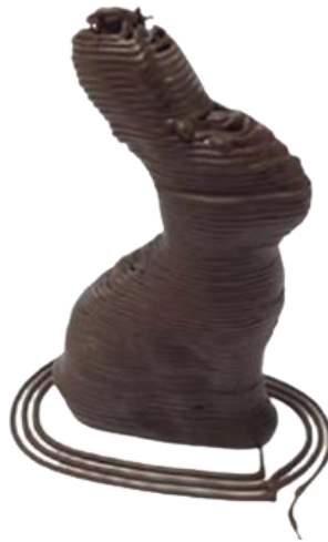
Abbildung 5: Hot-Melt extrusionsbasierter Prozess mit Schokolade
